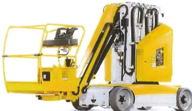
Maniable : rayon de braquage court. Electrique sur batterie d'une autonomie de 9h
